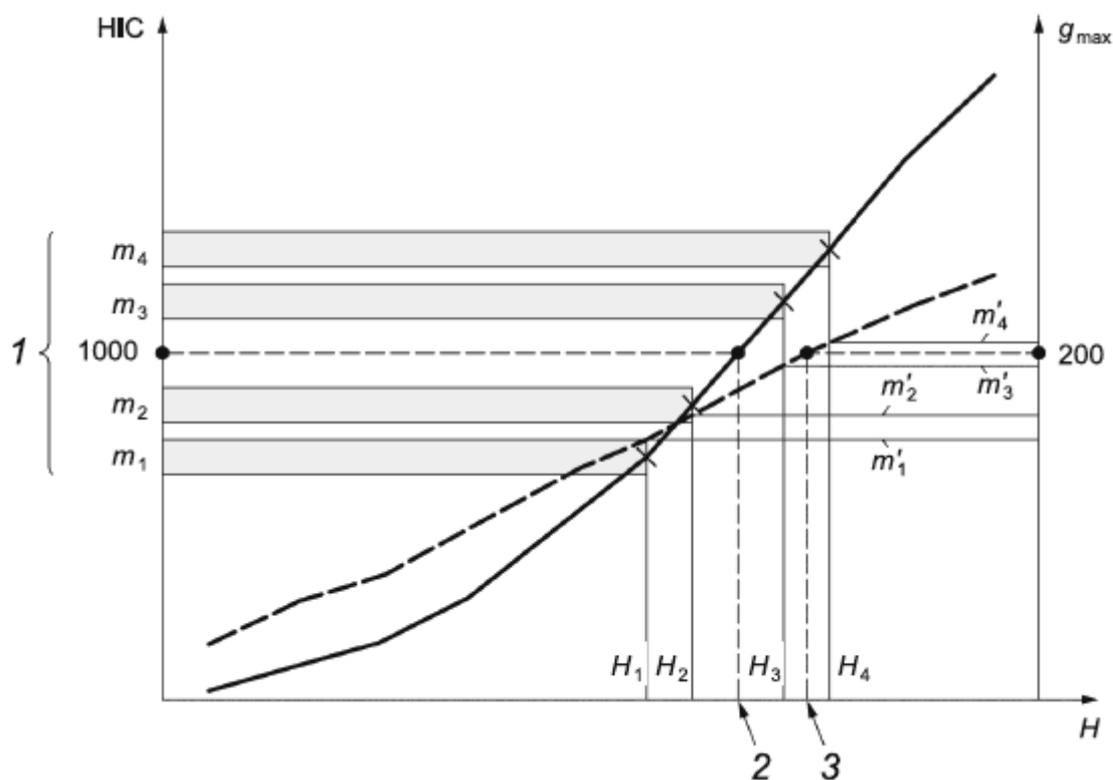
1 - измерения удара  $m_1 - m_4$  в HIC при высотах падения  $H_1 - H_4$ ; 2 - критическая высота падения при HIC=1000;
