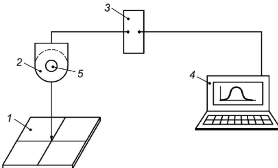
1 - испытуемый образец; 2 - модель головы; 3 - преобразователь сигнала (электрометрический усилитель) (при необходимости); 4 - регистрирующее устройство (компьютер); 5 - акселерометр
